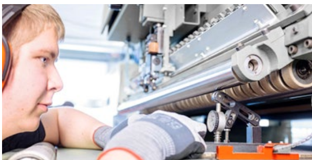
Der Servicetechniker kalibriert das Messsystem einer Gebrauchtmachine.
