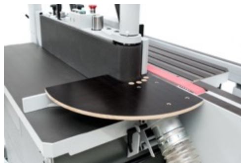
Schleifen von Außenrundungen
