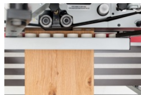
Schleifen von Außenrundungen
