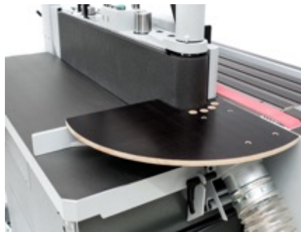
Schleifen von Innenrundungen
