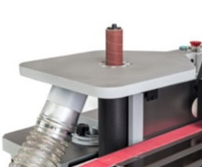
Schleifen von Innenrundungen
