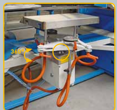
Dreh- und Schwenkeinrichtung zur Aufnahme von Behältern und verwinkelten Werkstücken (Kugel-Schwenkeinrichtung 30° in alle Richtungen)
