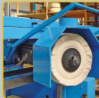
Schleif- und Polieraggregat zum Strukturieren, Schleifen, Bürsten, Glätten und Polieren
