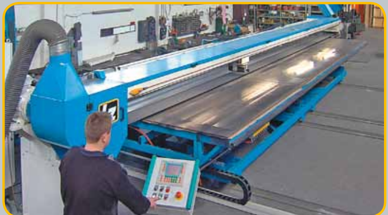
Vollautomatische Einband-Schleifmaschine Arbeitsbereich: 8.500 x 3.000 mm, Tischbelastung: 6.000 kg Fully automatic double belt grinding machine Workspace: 8,500 x 3,000 mm, table load: 6,000 kg
